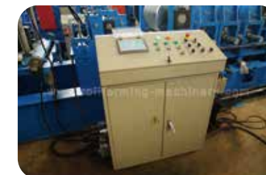
⑪ PLC 控制系统 PLC Control System
